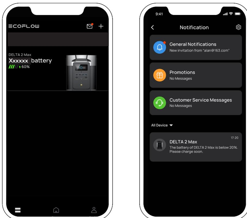
Lorsque la batterie est inférieure à 20 %, l'application EcoFlow émet une alerte de batterie faible.
